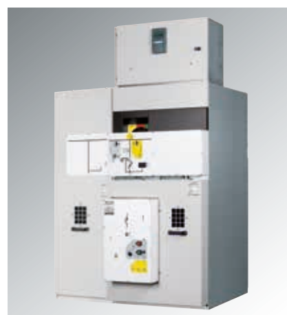
Celda de protección de transformador con seccionador SF6 e interruptor automático en vacío. Entrada de cables desde abajo, salida de cables por abajo, ancho 1250 mm.
