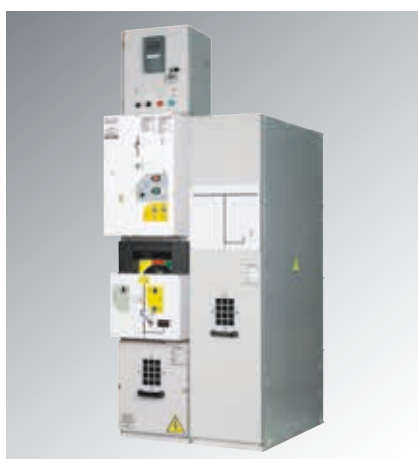
Celda de protección de transformador con seccionador SF6 e interruptor automático en vacío. Entrada de cables desde abajo, salida de cables por abajo, ancho 750 mm.
