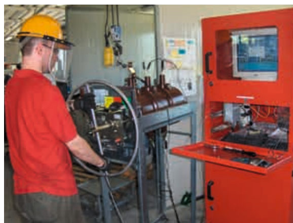
Medición de la velocidad de apertura y cierre.
